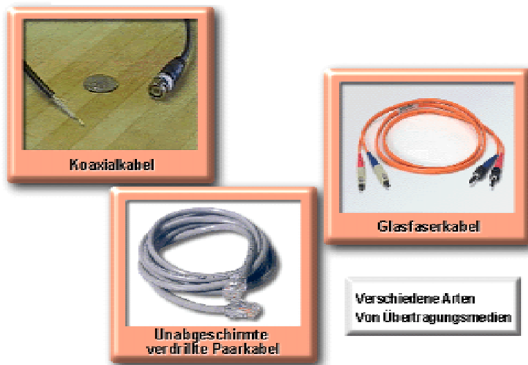
Abb.5.4: Beispiele für physikalische Übertragungsmedien
